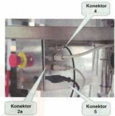
2-es kép: Kábelek csatlakoztatása a vezérlő asztalhoz
